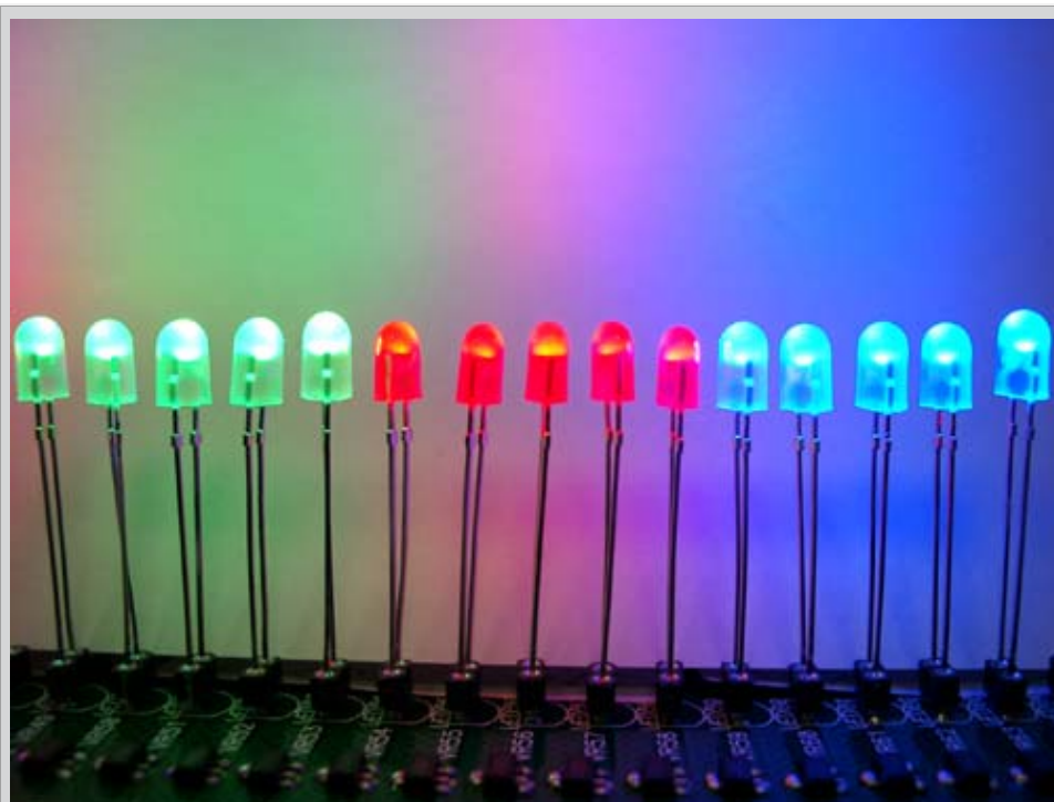
Рис. 11 Светодиоды фирмы "COTCO" типа LO5SMQ-BOG с овальной оптикой 110°x50°
