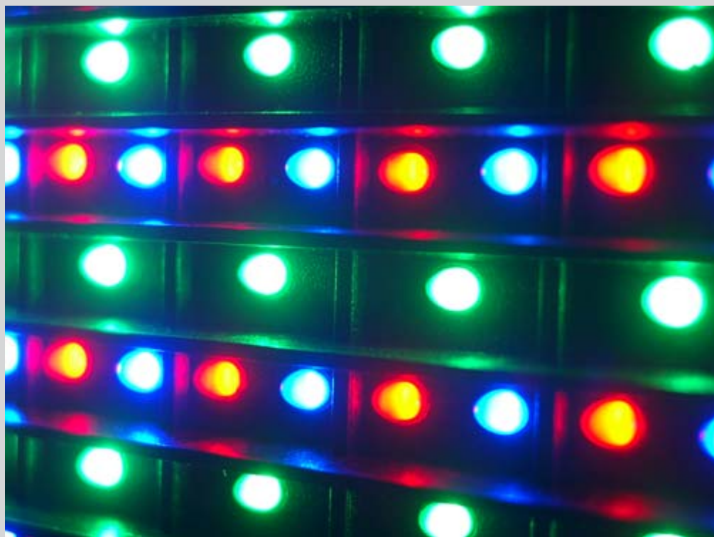
Рис. 10 Фрагмент полноцветного кластерного экрана. Пиксели собраны из светодиодов основных цветов.
