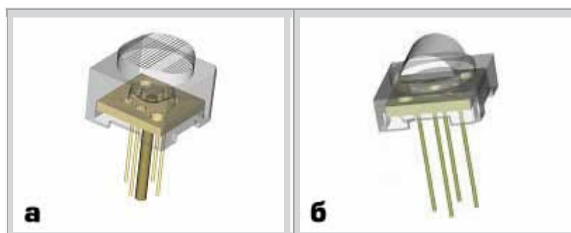
Рис. 15 а - светодиод с оптикой Френеля на цилиндре б - светодиод с обычной цилиндрической линзой
